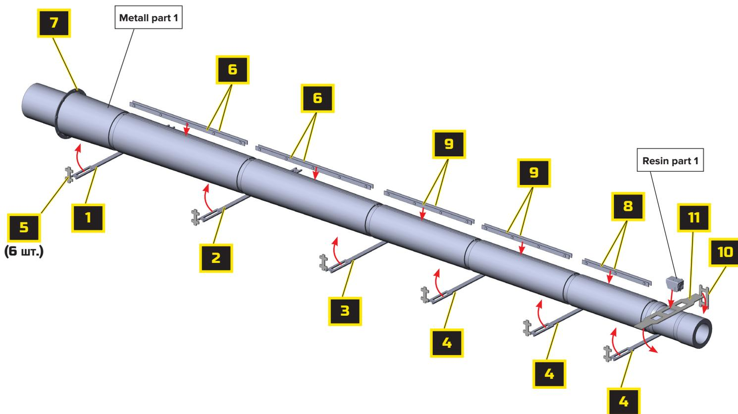
1. Обрезать пластиковый ствол для установки металлического.
